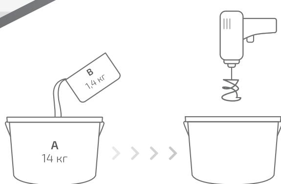
Двухкомпонентный полисульфидный заливочный герметик с повышенной стойкостью к воздействию УФ, выдерживает кратковременный контакт с грунтовыми водами и нефтепродуктами.
